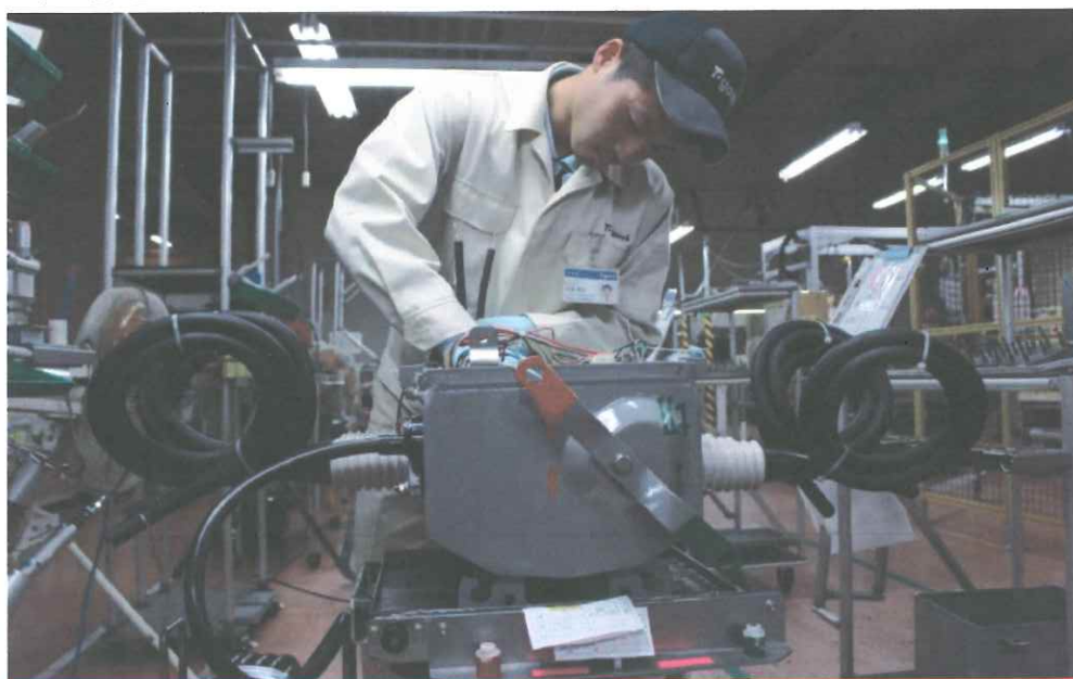
高圧開閉器の製造現場(戸上電機を紹介する記事より転載)
