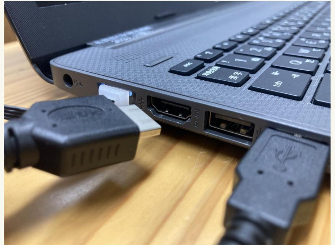
HDMIケーブルとUSBケーブルをパソコンに接続する
